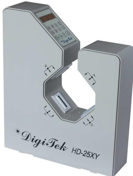
HD 系列鐳射外徑測試儀採用鐳射掃描技術，是測量速度快、精度高、測量重複性好的測量儀器。HD 系列鐳射測徑儀適用於各類電線電纜、漆包線、微拉絲、管材、玻璃管棒等的非接觸式外徑測量。HD 系列鐳射測徑儀可用於生產過程中的線上測試，並可以與顯示器或 PLC 連線通訊進行線上控制，在測量外徑的同時進行閉環控制減少材料損耗，幫助客戶節約成本。
