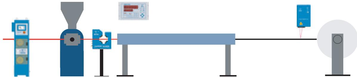
CS2G(XY) 处理来自D2的数据，DG系列测径仪位于冷却槽之前，代入收缩预设值（以绝对值或百分比形式），向挤出机发送控制信号。
